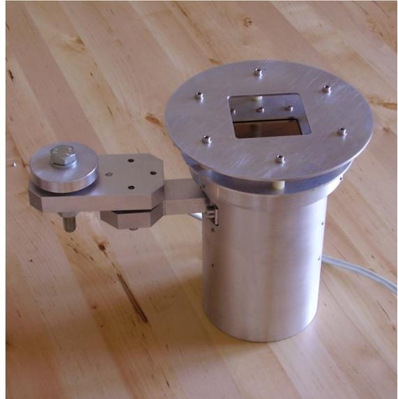
Acquisitore mod: AT-6448-2F-SE-0050 provvisto di filtro solare (IF) e di schermi radiazione (2S) per celostata o inseguitori solari (E). Il modello rappresentato è provvisto di sistema di ventilazione per temperature comprese tra 0 e 45 gradi centigradi (0050). Nella versione cooled la camera può operare da -25 a +70 gradi.
