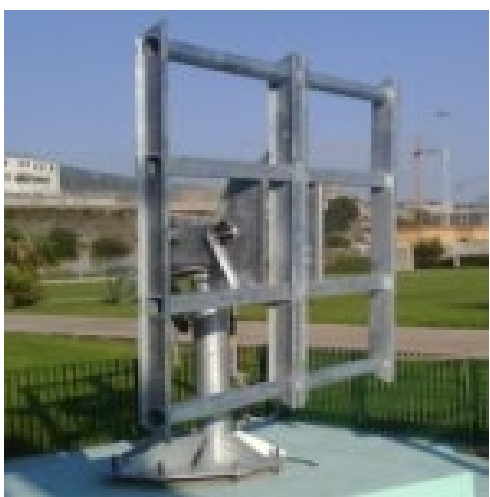
L'inseguitore Pillar#04realizzato per test e caratterizzazione di moduli sia a concentrazione che tradizionali.
