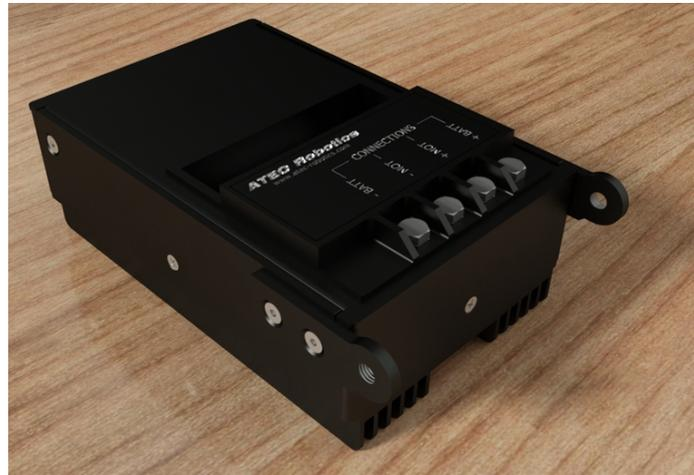
Il radiatore in alluminio anodizzato consente la dissipazione del calore prodotto da alcuni componenti elettronici. La temperatura del radiatore è rilevata e riportata nei dati di funzionamento. In caso di superamento del limite di temperatura previsto la centralina interrompe l'alimentazione al motore. I punti di fissaggio della centralina alla bici sono stati realizzati in modo perfettamente compatibile con quelli originali Aprilia.
